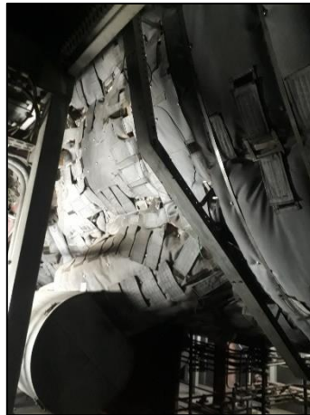
รูปที่ 2-16 ระบบฉนวนป้องกันความร้อน หรือฉากป้องกันความร้อน
